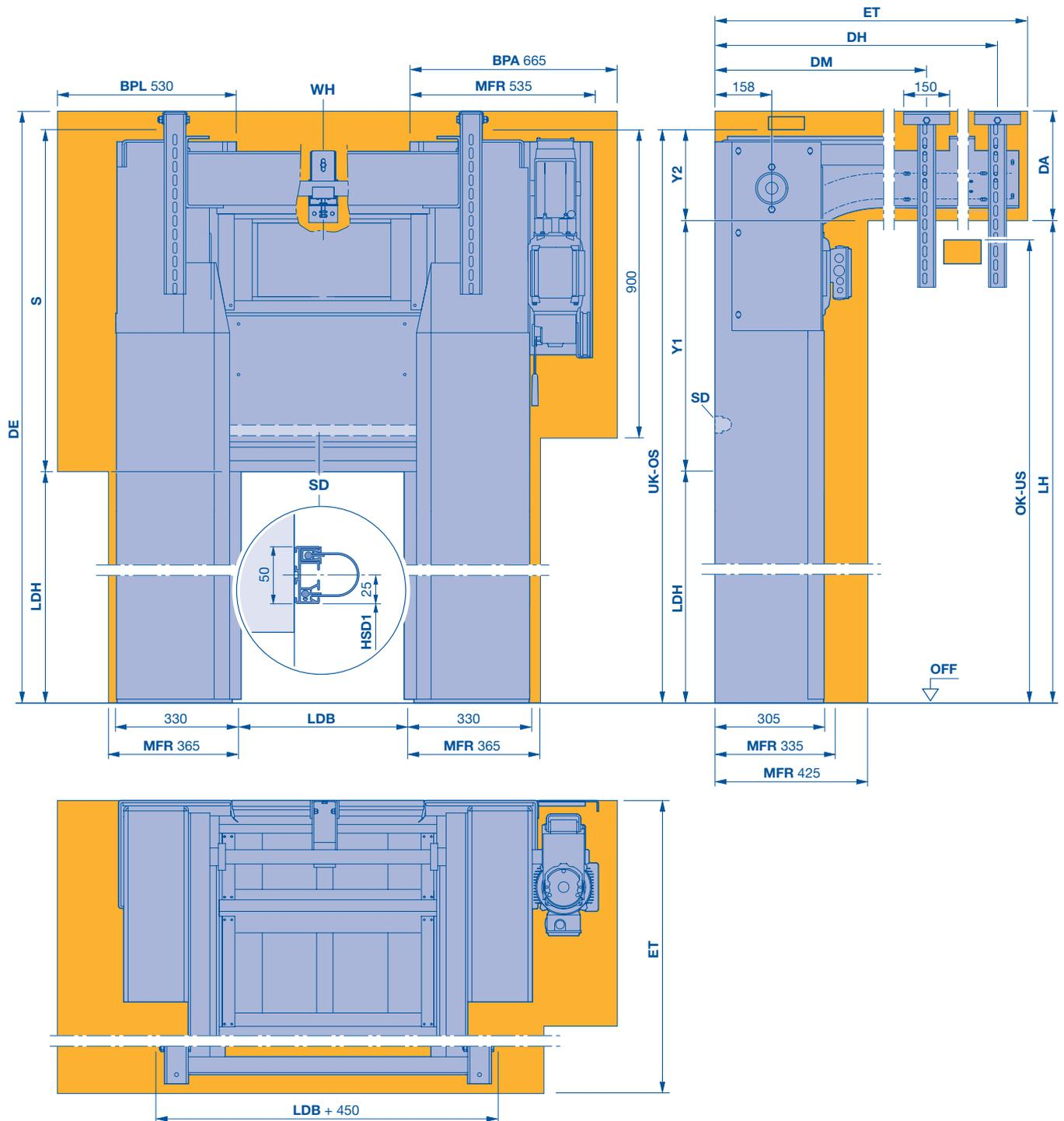
**BPA** Benötiger Platzbedarf für Montage und Demontage Antrieb
