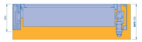
**BPA** Benötiger Platzbedarf für Montage und Demontage Antrieb
