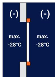
Montage innerhalb Tiefkühlbereich (beidseitig) im Idealfall in Kombination mit einem isolierenden Tiefkühlabschluss
