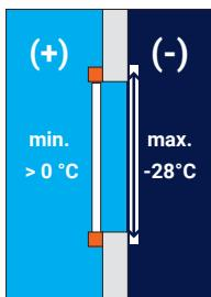
Montage außerhalb Tiefkühlbereich nur in Verbindung mit einem isolierenden Tiefkühlabschluss im Tiefkühlbereich (Tiefraumschiebe-tor etc.)
