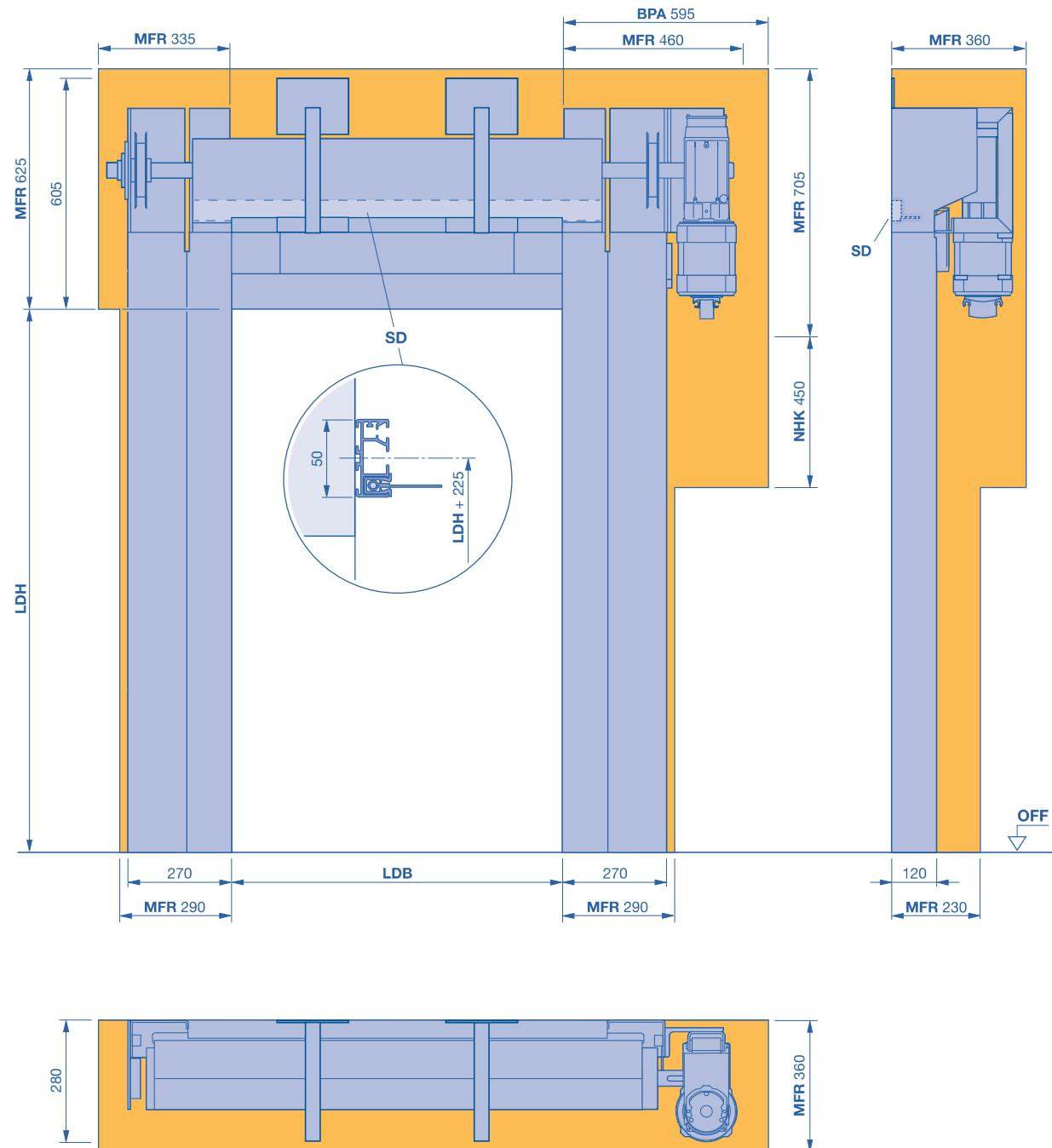
**BPA** benötigter Platzbedarf für Montage und Demontage Antrieb
