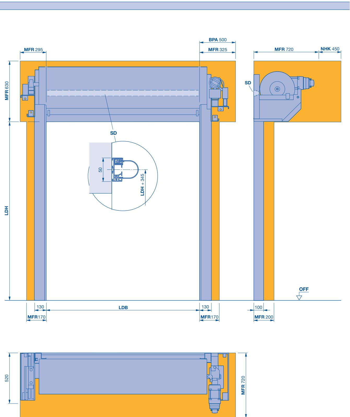
**BPA** benötigter Platzbedarf für Montage und Demontage Antrieb
