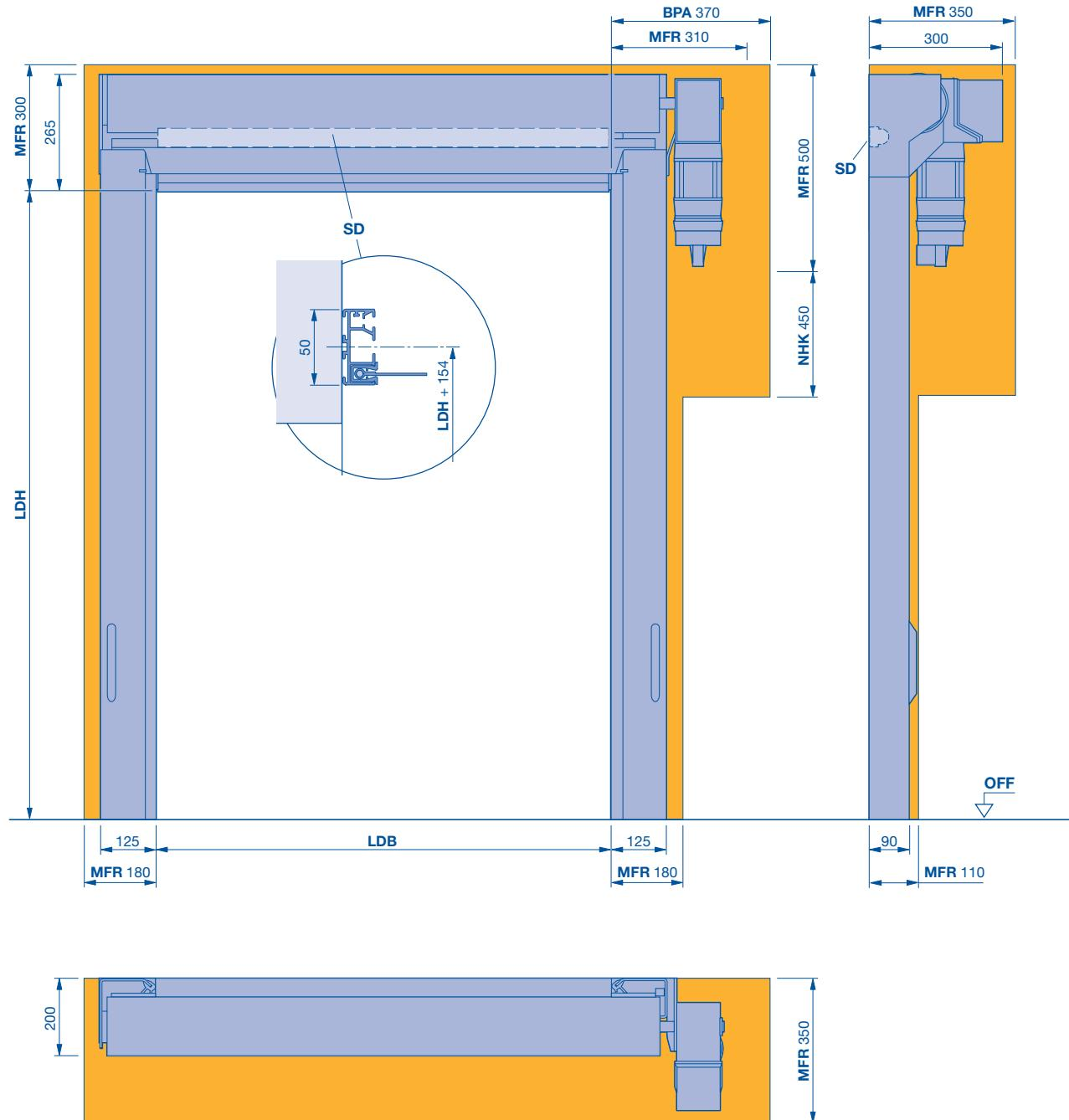
**BPA** benötigter Platzbedarf für Montage und Demontage Antrieb
